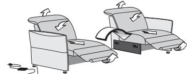
Bei Funktionsteilen mit motorischer Funktion befindet sich der Anschluss für die Stromversorgung am hinteren Ende des Seitenteils.
