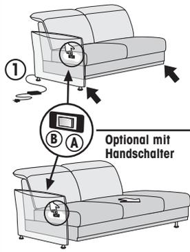
**1** Sicherungsschnur (☛) an der Unterseite beidseitig entfernen. Motorkabel mit dem Netzteil (1) verbinden und Netzkabel an eine Steckdose anschließen.
