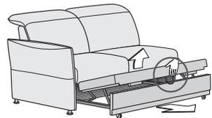
2 Greifen Sie mittig unter die Fußteilblende und ziehen Sie diese nach vorn heraus, bis die volle Liegefläche erreicht ist. Durch Anheben (Stoffschlaufe) wird der Schwenkrahmen in Liegeebene gebracht.
