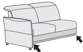
1 Sicherungsschnur an der Unterseite beidseitig entfernen. Seitliches Brett (Spanplatte) abschrauben und Schrauben M6x20 aus Folietüte entnehmen. Beide Beschlagteile mit je 1 Stück Kreuzschlitzschraube an der Seitenfläche befestigen (Schraubenlöcher sind ausgeschnitten).
