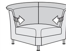
Die Relaxecke ist mit zwei nach innen schwenkbaren Rückenlehnen versehen. Fassen Sie an die Außenkante der Lehne und ziehen Sie diese zu sich heran, bis diese in der gewünschten Relaxposition einrastet.
