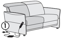
① Motorkabel mit dem Netzteil verbinden und Netzkabel an eine Steckdose anschließen.
