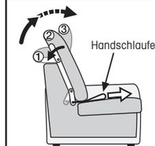
Die Verstellung der Kopfstütze erfolgt bei allen Typen mit TV-Funktion durch eine Handschlaufe. Diese ist am unteren Rand der Rückenlehne etwas seitlich angebracht und kann bei Nichtgebrauch zwischen Rücken- und Sitzpolster verborgen werden. Durch Ziehen in Richtung Sitzvorderseite bewegt sich die Kopfstütze nach oben bis Lehne und Kopfteil eine Ebene bilden (Stellung ②).
