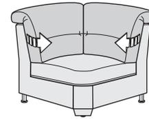
Die Relaxecke ist mit zwei nach innen schwenkbaren Rückenlehnen versehen. Fassen Sie an die Außenkante der Lehne und ziehen Sie diese zu sich heran, bis diese in der gewünschten Relaxposition einrastet. 4 Lehnenstellungen sind möglich.
