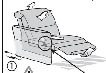
① Motorkabel mit dem Netzteil verbinden und Netzkabel an eine Steckdose anschließen.
