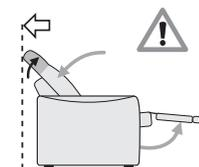
**Bei Typen mit TV-Funktion und Longchair VitalComfort vor dem Absenken in Liegeposition mit aufgestellter Kopfstütze auf 15 cm Wandabstand achten!**
