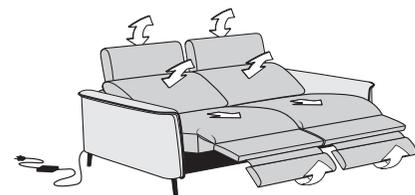
Bei Funktionsteilen mit motorischer Funktion befindet sich der Anschluss für die Stromversorgung am hinteren Ende des Seitenteils. Müssen mehrere Elemente mit motorischer Funktion miteinander verbunden werden, führen sie zuerst diesen Schritt aus.
