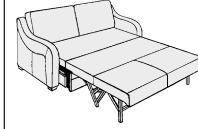
Die **Rückverwandlung** erfolgt, indem man in die Griffmulde faßt, die Liegefläche etwas anhebt, in sich zusammenklappt und bis zum Anschlag hineinschiebt.
